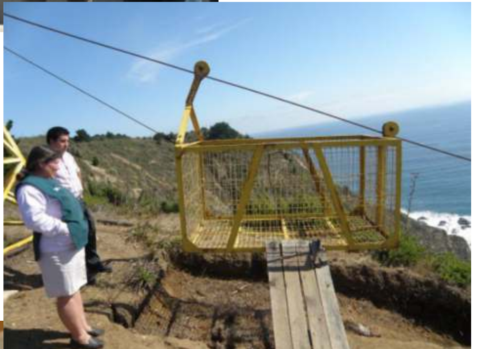
Vista del mecanismo utilizado para el traslado de algas desde la base del acantilado en la zona de Matanzas
